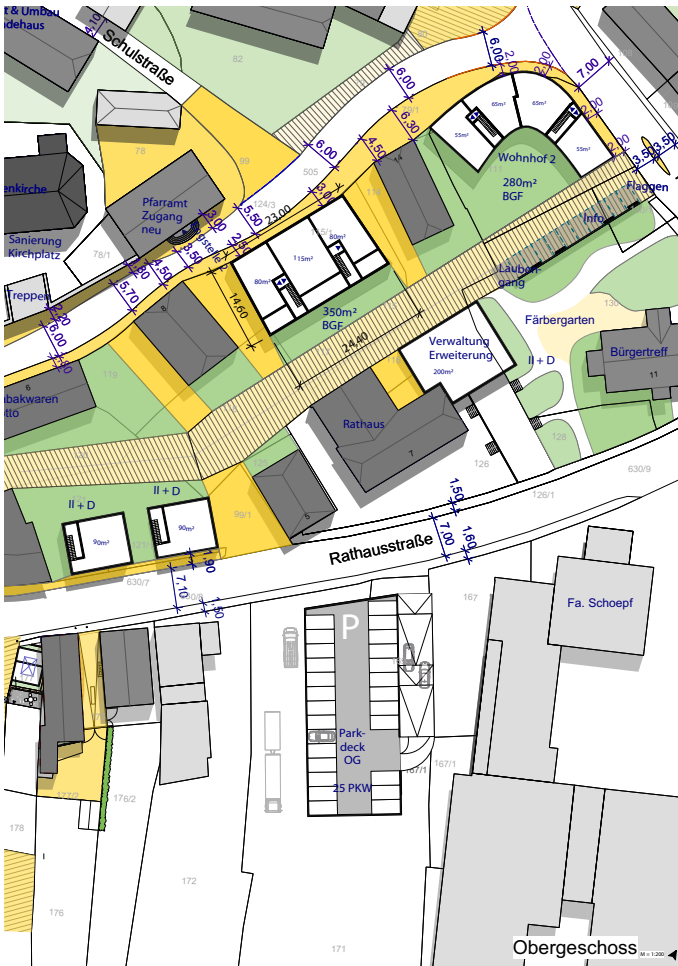
Abb. 32 Grundriss Neubauten Rathausquartier- Obergeschoss
